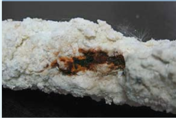
Vermeidbare Energieverluste durch Kalk: verkalkte Opferanode eines Warmwasserspeichers (l.), verkalkter Warmwasserspeicher (r.)
